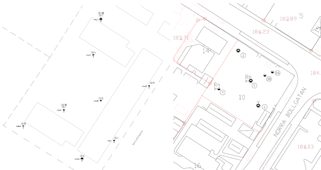
Figur 23: Sonderingspunkterna inom Falken 16 åt vänster. På bilden åt höger syns punkterna från den geoteknisk undersökning som gjordes 2013 inom fastigheten Falken 10
