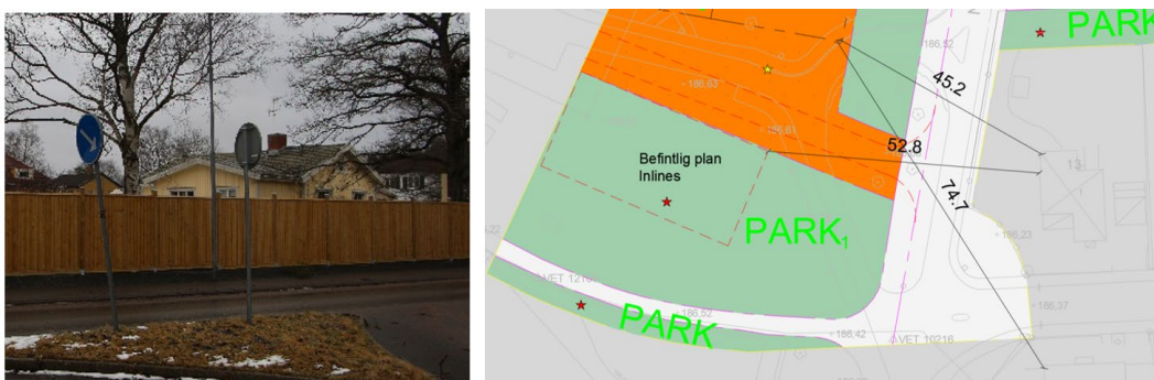
Figur 34: Bilden visar det närmaste bostadshus med des bullerplank samt avståndet till framtida byggrätt och befintlig streethockeyplan (inlines).
