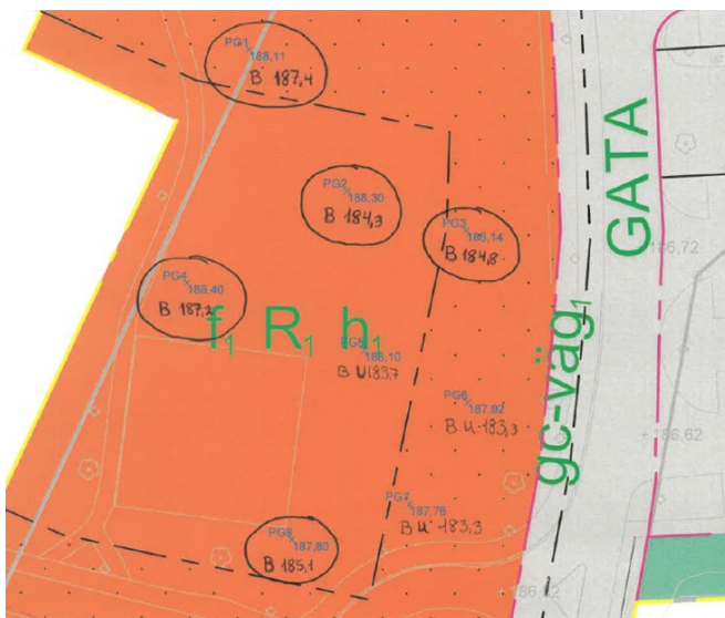
Figur 25: Sonderingspunkterna inom kvartersmark där sporthall är tänkt att byggas. Läget för provgroparna markerade med PG1 - PG8 samt marknivån (+ nivå i meter över havet) vid respektive provgrop. I de inringade provgroparna har bergytan påträffats och värdena visar bergytans nivåer.
