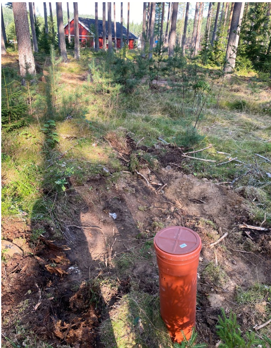
I förgrunden radonmät punkt R1 följt av igenfylld provgrop G1 och idrottspaviljong i bakgrunden.
